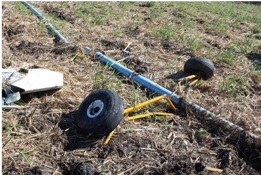
Fig. 3 – Imagen del tren de aterrizaje principal
