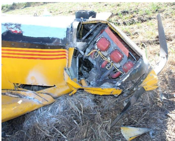
Fig. 2 – Imagen del motor y hélice con el daño en las palas.
