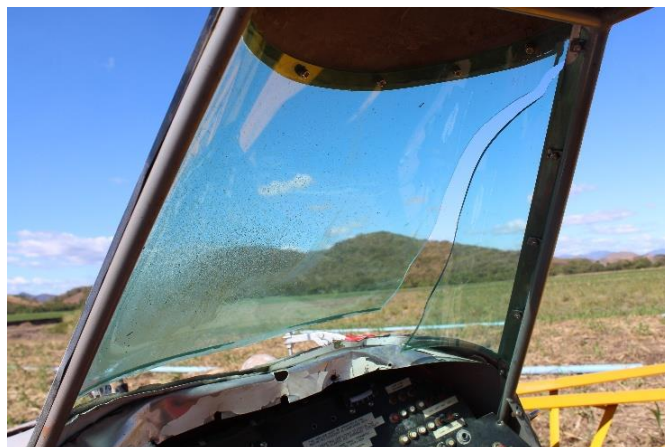
Fig. 5 – Imagen de su windshield quebrado.
